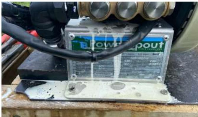
水側シールが摩耗し、オイル側シールを通過した水の侵入を示す画像。
